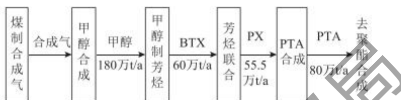
图 1-5 180 万 t/a 甲醇制 55.5 万 t/aPX 方案
